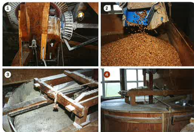
① Les impressionnants rouages du moulin à vent ② Les grains de blés sont vidés dans la trémie ③ Une fois propre, le grain est moulu sur la meule de pierre ④ La meule d'un mètre soixante-cinq est faite de quartz silex originaire de carrières françaises fermées depuis la guerre...
